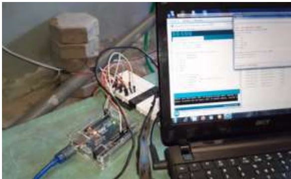
Gambar 9. Koneksi sensor, Arduino dan komputer
